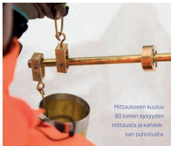
Raine Revonmäki mittaa lumen paksuuden ja ottaa näytteen puntariin. Mittauksia tehdään samoista kohdista säännöllisesti läpi talven.
